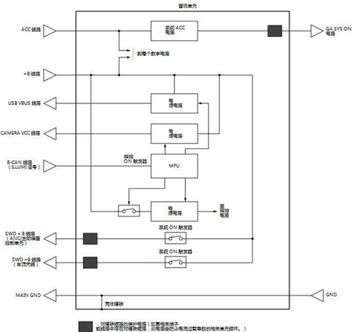
■：对搭铁短路的保护电路（如果相关端子或线路中存在对搭铁短路，此电路会防止电流过载导致的相关单元损坏。）
